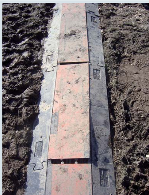
Les passages de câbles ont le mérite d'éviter les chutes pour le public tout en protégeant et isolant l'accès aux connecteurs eux-mêmes.
