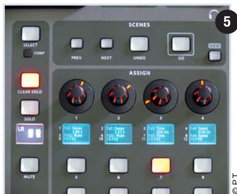
05 / Les contrôleurs assignables et leur petit afficheur (ils sont ici affectés à des paramètres d'effets), surmontés par la section de rappel des mémoires (scènes).
