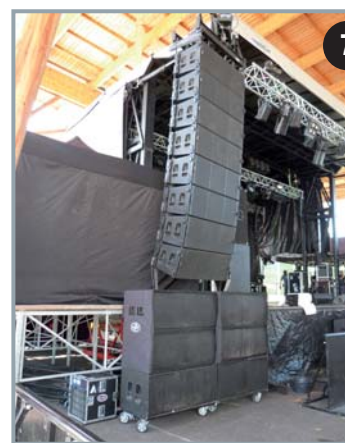
7 / Un côté du système DAS, avec 8 boîtes Aero 50 et 6 caissons Aero LX218.
